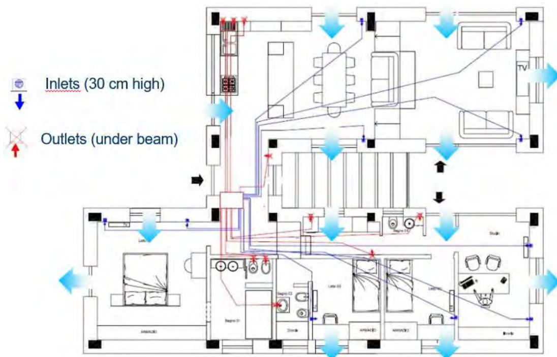
**Fig. 20** NATURAL AND MECHANICAL AIR DISTRIBUTION SCHEME
