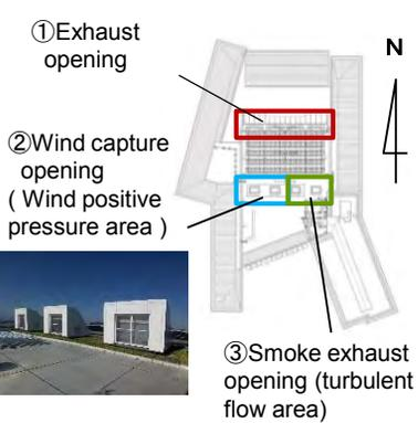
Fig. 15 RF SITE PLAN
