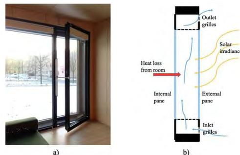
Fig. 10 A) THE SOUTH WINDOW, PHOTO SOLVEIG BLANDKJENN, B) WINDOW PRINCIPLE
