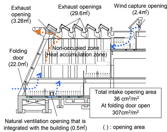
Fig. 13 SINGLE-SIDED VENTILATION PRINCIPLE
