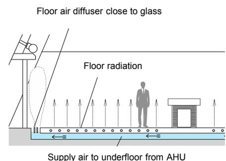
**Fig. 20** 1F & 4F AIR CONDITIONING SYSTEM
