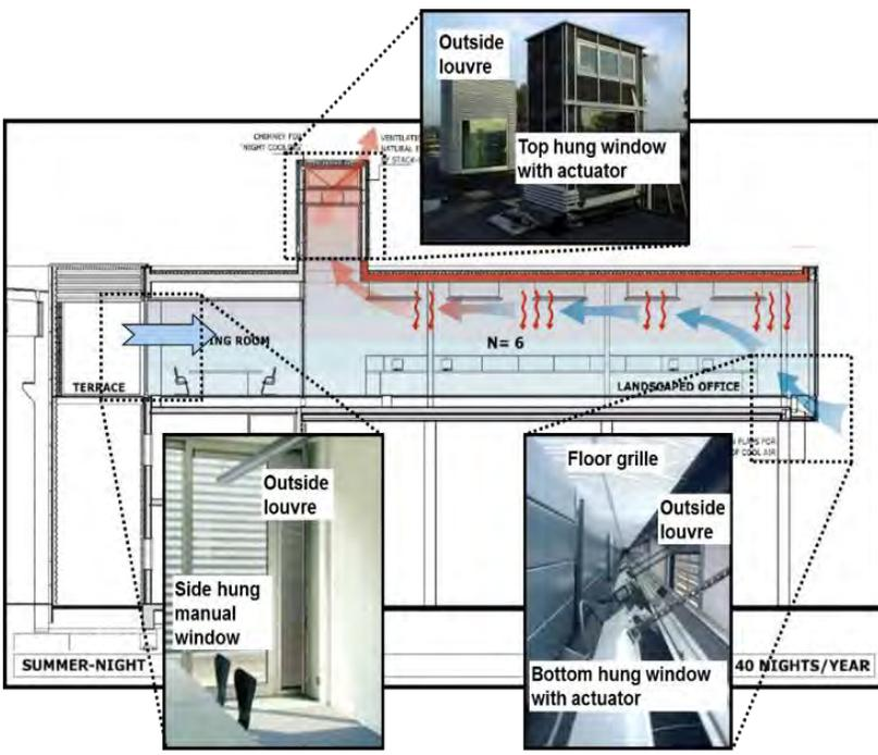
Fig. 9 NIGHT VENTILATION PRINCIPLE
