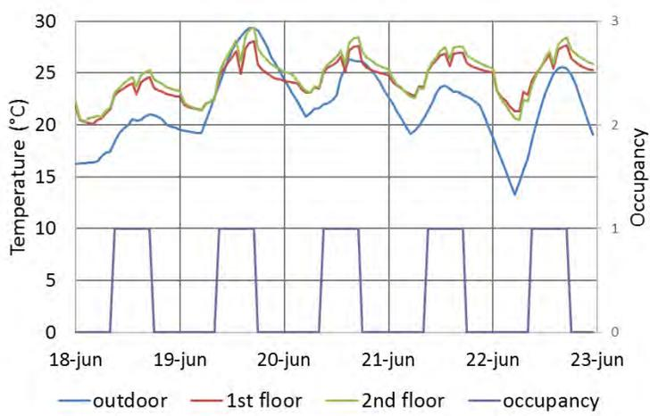
**Fig. 16** INDOOR TEMPERATURES WITH NIGHT VENTILATION
