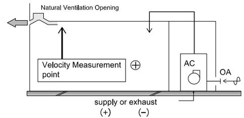
**Fig. 23** ESTIMATION OF THE DISCHARGE COEFFICIENT IN THE FIELD MEASUREMENT
