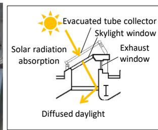
Fig. 10 SECTION OF SKYLIGHT WINDOW
